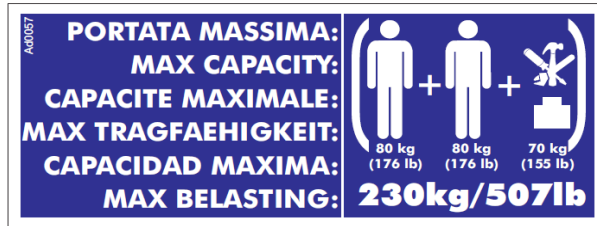
Afbeelding 70: maximaal toelaatbare belasting korf.
